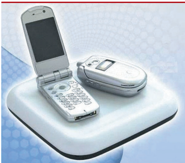
FOTO 4 ▶ Ricaricatore senza fili basato su induzione magnetica.
