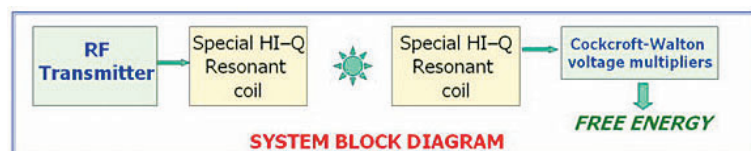
FIGURA 7 Schema a blocchi di un sistema per la trasmissione di energia in campo evanescente
