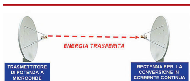
FIGURA 2 L'energia a microonde ricevuta viene convertita in corrente continua da una rectenna (da rectifier e antenna).
